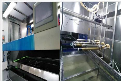
自动除尘喷涂光固化线
