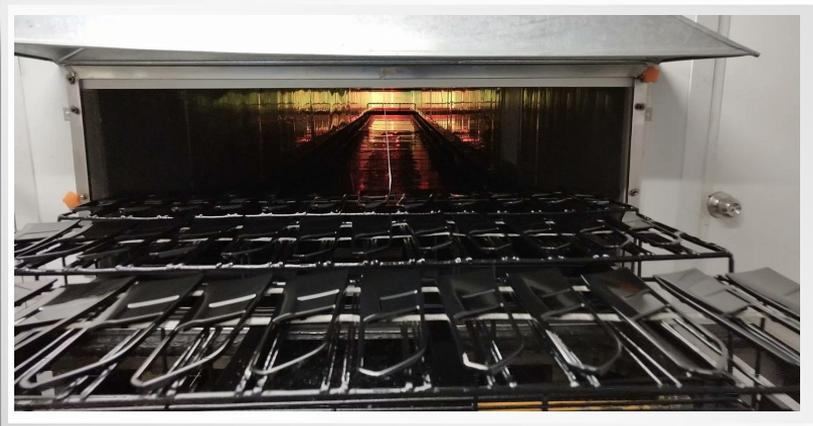
产品喷涂完成，进入隧道流平、UV固化、烘烤、冷却自动流出
